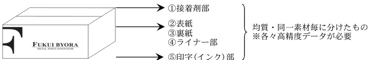
※ダンボールは、上記の通り接着剤部、表紙、裏紙、ライナー部、インク部にて構成されております。よって高精度分析は、各々の材料、原料により分析して下さい。
