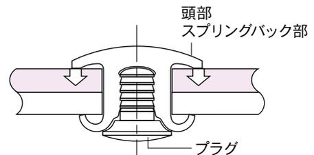
プラグの効果と、頭部のスプリングバックにより、締結部の緩みを抑えます。
